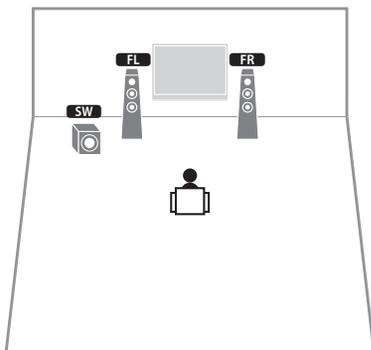
即使在未连接环绕声音箱的情况下，本机也可使用前置音箱创建虚拟环绕声音箱来让您欣赏多声道环绕声（Virtual CINEMA DSP）。
