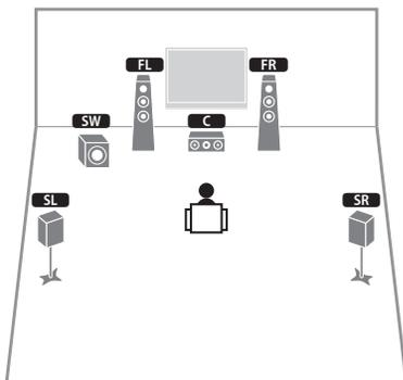
该音箱系统使用前置、中置和现场感音箱生成自然的三维声场，创建 Virtual Presence Speaker (VPS)，也会使用环绕声音箱向真实声场中添加深远的感觉，创建 Virtual Surround Back Speaker (VSBS)。该系统不仅仅适合享受 5.1 声道，而且也适合享受 7.1 声道的内容。
