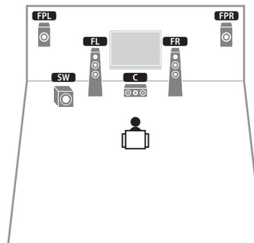
本音箱系统使用前现场感音箱建立自然的三维声场，并使用前置音箱创建虚拟环绕声音箱来让您欣赏多声道环绕声（Virtual CINEMA DSP）。
