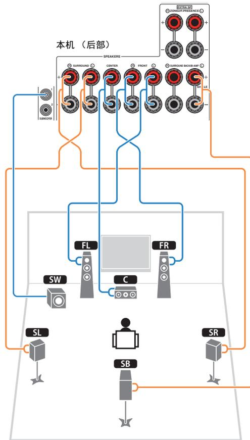
只使用一个后环绕声音箱时，将其连接至 SINGLE 插孔（左侧）。
