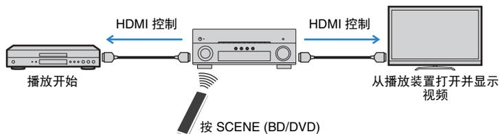
若要使用 HDMI 控制，您需要在连接电视和播放装置后执行以下 HDMI 控制链接设置。有关电视的设置和操作的详情，请参见电视使用说明书。
