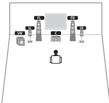
即使将环绕声音箱放置在前侧，将“设定”菜单中的“扬声器配置（环绕声）”（第 104 页）设置为“前”时，本机创建的虚拟后置环绕音响能够让您体验多通道环绕声（Virtual CINEMA FRONT.）
