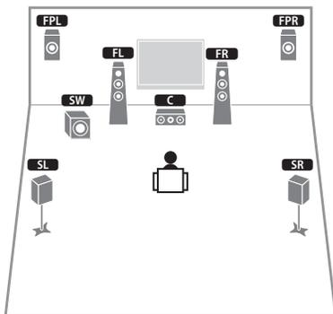
该音箱系统使用前置现场感音箱生成自然的三围声场，也会使用环绕声音箱向真实声场中添加深远的感觉，创建 Virtual Surround Back Speaker (VSBS)。该系统不仅仅适合享受 5.1 声道，而且也适合享受 7.1 声道的内容。
