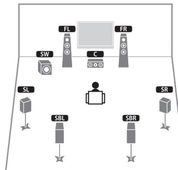
本音箱系统使用前置音箱、中置音箱和环绕声音箱来创建 Virtual Presence Speaker (VPS)，从而建立三维声场，通过该系统，您还可以使用后置环绕声音箱欣赏增强的环绕声音。
